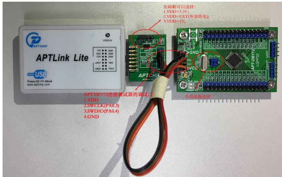
APTLink Lite 仅支持在线仿真和烧录使用，前提条件是 SWCLK 和 SWDIO 没有用作其他 IO 功能。若调试口用做其他 IO 功能，则不能用 APTLink Lite 调试和烧录，只能用 APT-WD01 擦除 APT32F172 后才能连接 APTLinkLite。
