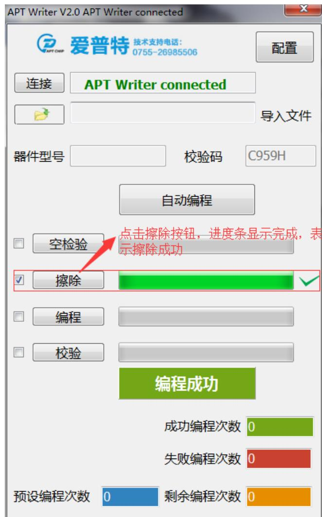
3、确认是否连接成功，然后点击“擦除”按钮，进度条显示完成，表示擦除成功。
