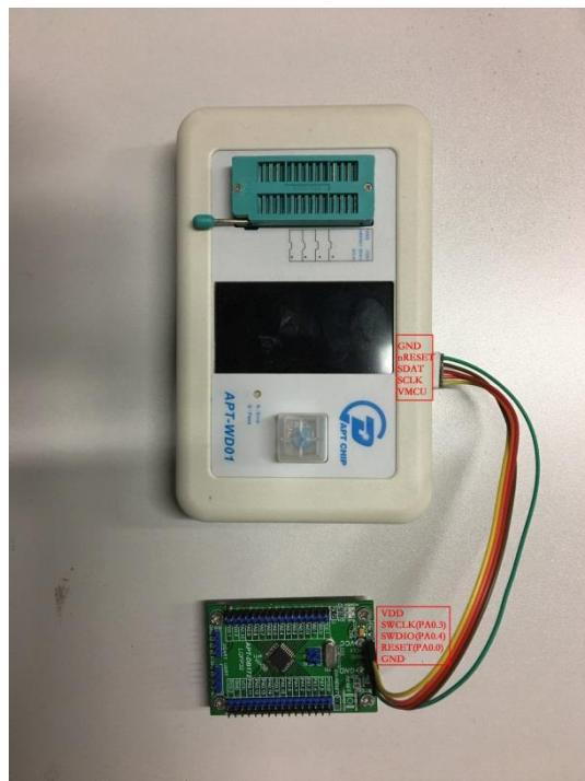
烧录脚位：VDD、SWCLK (PA0. 3)、SWDIO (PA0. 4)、RESET (PA0. 0)、GND
