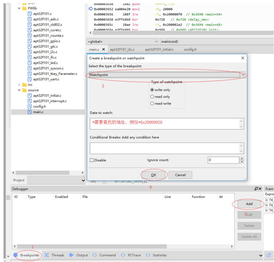
添加完成后，CDK 仿真全速跑，当设置的地址里面数据发生改变，CDK 立刻停止，且停在改变变量的代码处。
