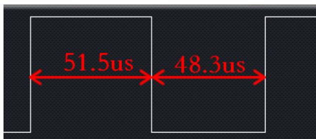
打开比较器滤波使能，选择经过滤波器后输出。
